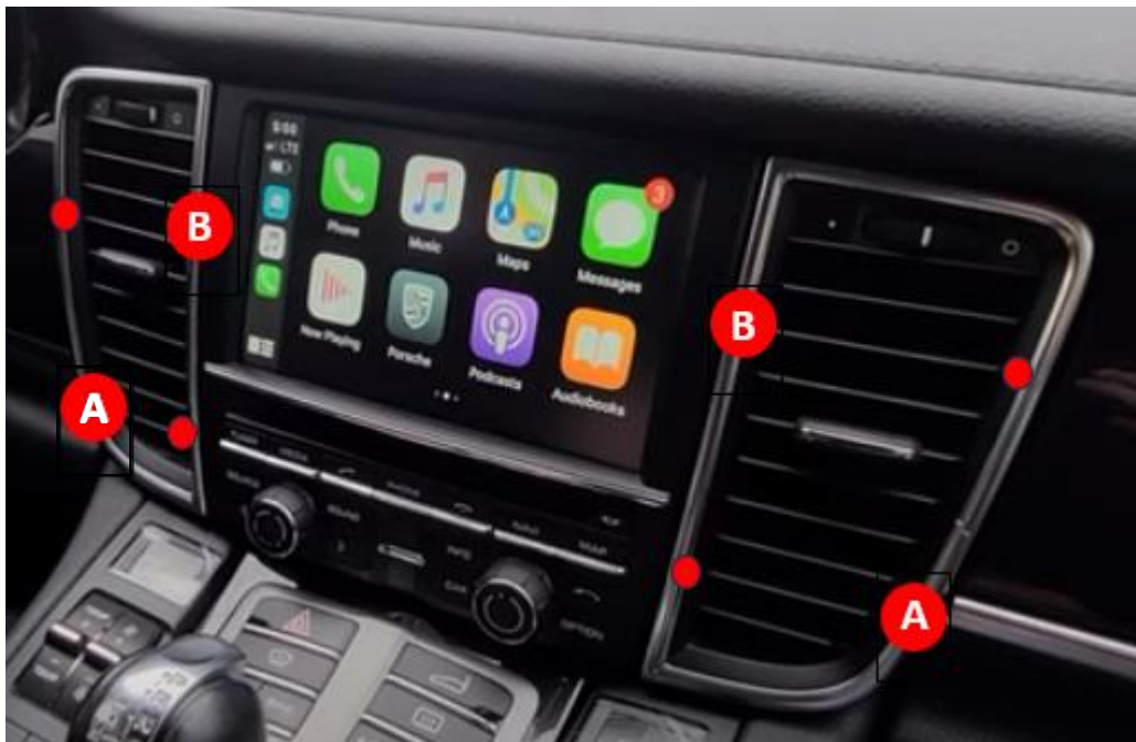
Afbeelding 1: speciale ontgrendelingshaken, Afbeelding 2: eenvoudige haken
